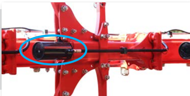
Trupițele 1 și 4 cu alezaj sporit al cilindrului.
