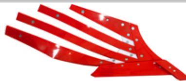
MP4N - Cormană lamelară, semi-elicoidală, ideală pentru soluri grele/umede. (Adâncime de lucru 20 - 30 cm).
